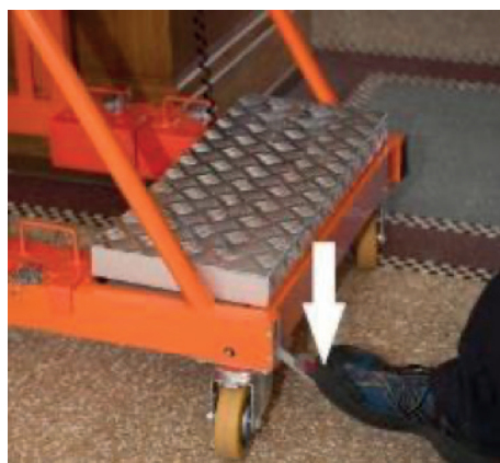
Foto 20, 125 mm industrihjul Trampa på pedalen för att låsa hjulen.
