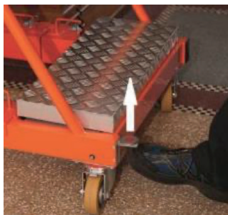
Foto 21, Upplåsning av hjul Lyft pedalen för att lossa alla dom fyra hjulen.
